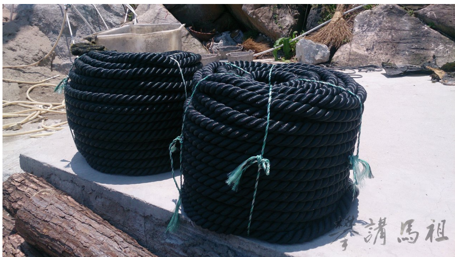
圖 26.1: 尼龍材質的筋索
